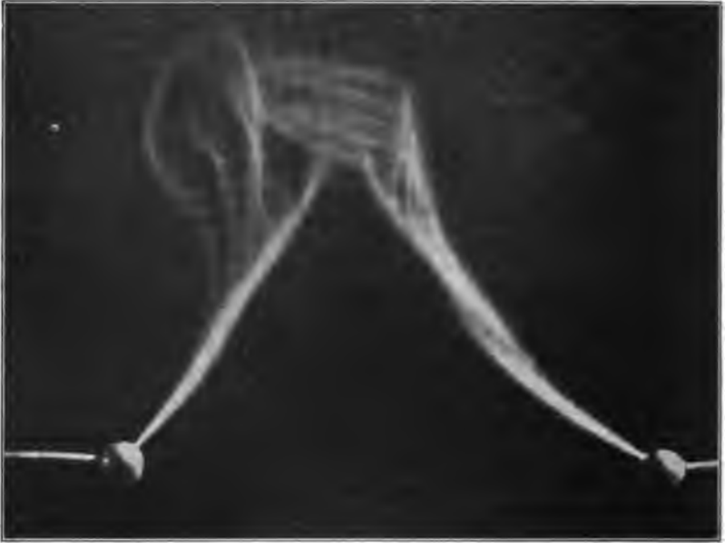
Abb. 278. Inaktive Entladung (Lichtbogen) eines Transformators.
